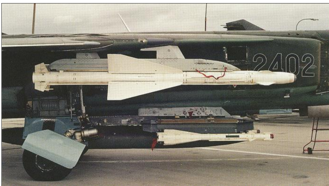
Nejčastější konfigurace výzbroje MiGů-23ML. Celkem 3 infra řízené střely (2x R-60, 1x R-23T) + na levém odpalovacímzařízení, které zrovna není vidět 1x radiolokační R-23R + podtrupová přídavná nádrž 800 l.
