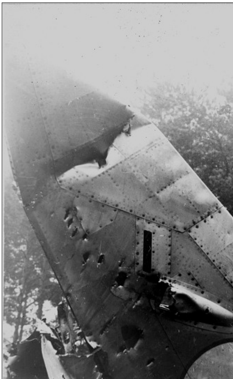
Trosky havarovaného letounu MiG-21F-13, v.č. 460111 majora Václava Ohema. Letoun dopadl poblíž malého města asi 15 km jižně od Postupimi. Na obrázku jsou jasně vidět stopy po explozi raketou vzduch-vzduch K-13/R-3S
